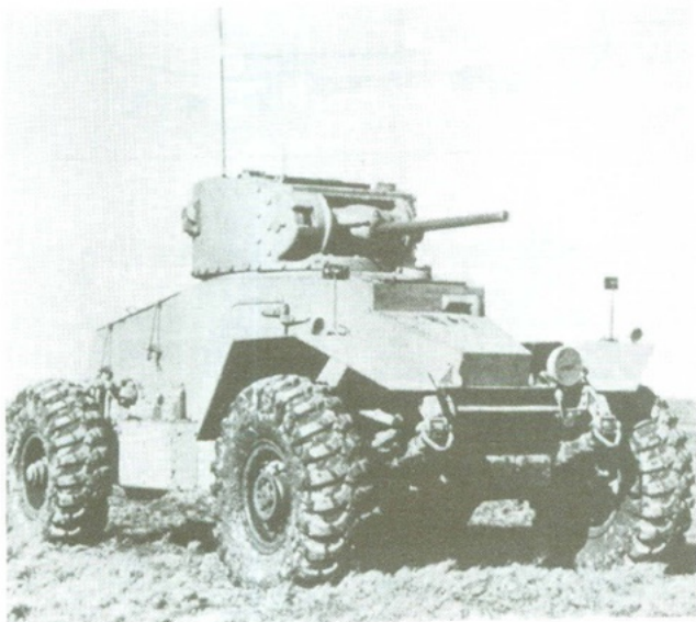
De AEC Mk.I tijdens de eerste beproevingen. De romp heeft al voor een groot deel zijn definitieve vorm, de spatborden zijn nog 'in wording'. Boven de achterwielen ontbreken ze geheel. (foto: Bovington Tank Museum).
